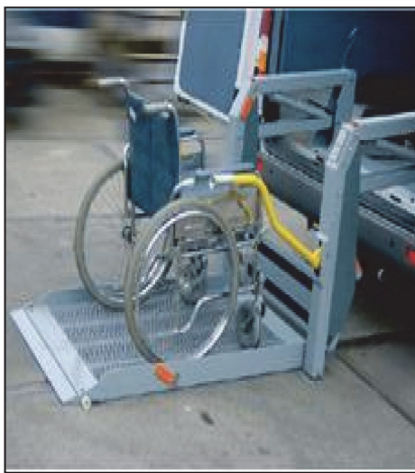
Obr. 6a, b – Sanitné vozidlá vybavené plošinami
