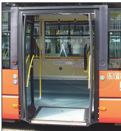
Obr. 1a, b – Zdvihacia plošina a priestor pre umiestnenie invalidného vozíka
