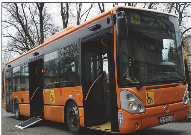
Obr. 1a, b – Zdvihacia plošina a priestor pre umiestnenie invalidného vozíka
