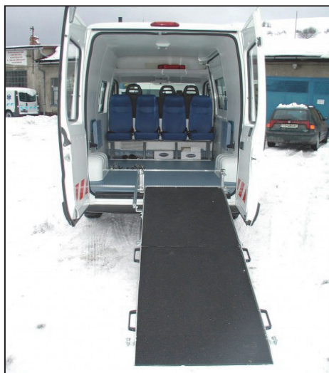
Obr. 6a, b – Sanitné vozidlá vybavené plošinami
